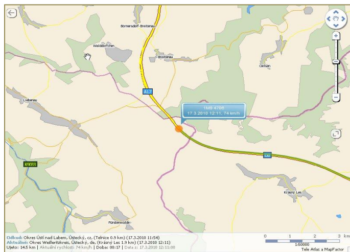
Rysunek 5 Wizualizacja na ekranie dyżurnego podstawowych parametrów (nr, data, godzina, prędkość) dotyczących konwoju przewożącego materiały niebezpieczne
