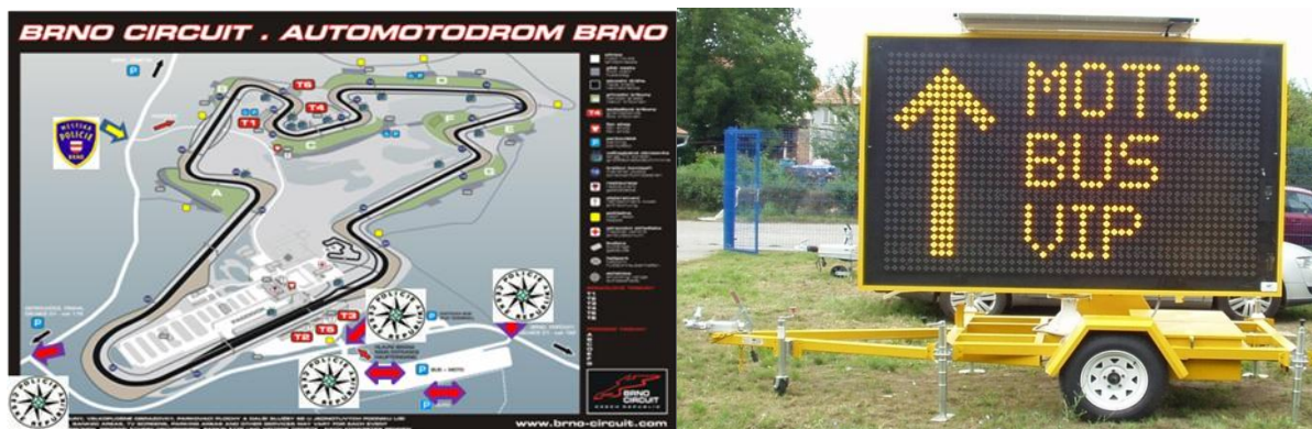
Rysunek 9 Po lewej - tor wyścigowy koło Brna, na którym szkoleni są policyjni kierowcy. Po prawej – przyczepa znajdująca się na wyposażeniu ogniwa „WRD“, umożliwiająca podawanie komunikatów. Urządzenie zasilane jest z akumulatorów i baterii słonecznej. Komunikaty wpisywane są sms-em lub z laptopa. Rozsuwany maszt, umożliwia podniesienie tablicy na wysokość do 3 m.
