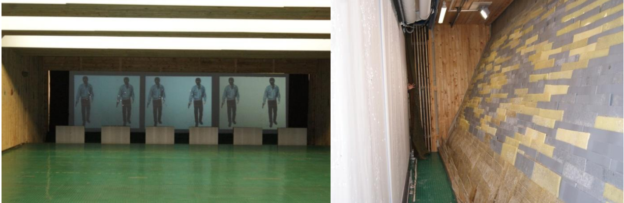
Zdjęcie 25 Po lewej - na ekranie wyświetlane mogą być postacie lub sytuacje. Po prawej - szeroka taśma przesunięta względem pierwszej warstwy, powoduje przesłonięcie przestrzelin
