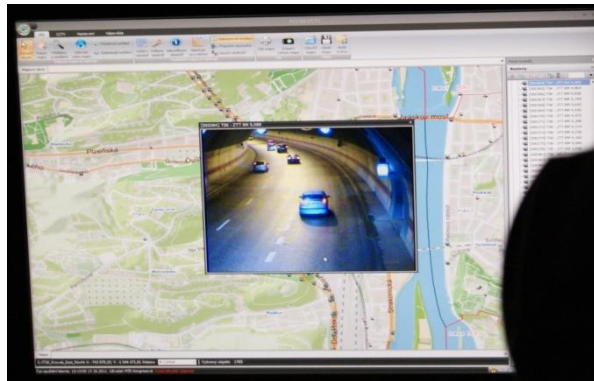
Zdjęcie 15 Po lewej - ekran dyżurnego, na którym w postaci czarnych ikon zaznaczone jest rozmieszczenie kamer praskiego monitoringu. Po prawej – naciśnięcie wybranej ikony włącza podgląd z żądanej kamery.
