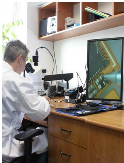
Laborant lutujący układy scalone.
